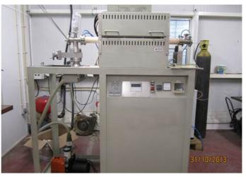
Zirkonzahn sintering furnace  $T_{max}$ =1.700°C
