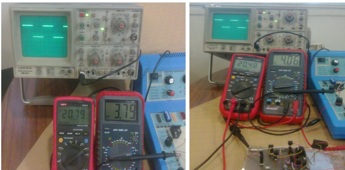
Figura 93 - Corrente de carga (multímetro da esquerda), Tensão na bateria (multímetro da direita) e controlo de Corrente no reóstato
