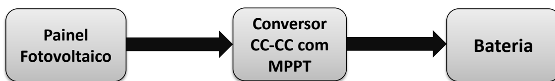
Figura 3.1 - Diagrama de bloco do sistema de carregamento da bateria.
