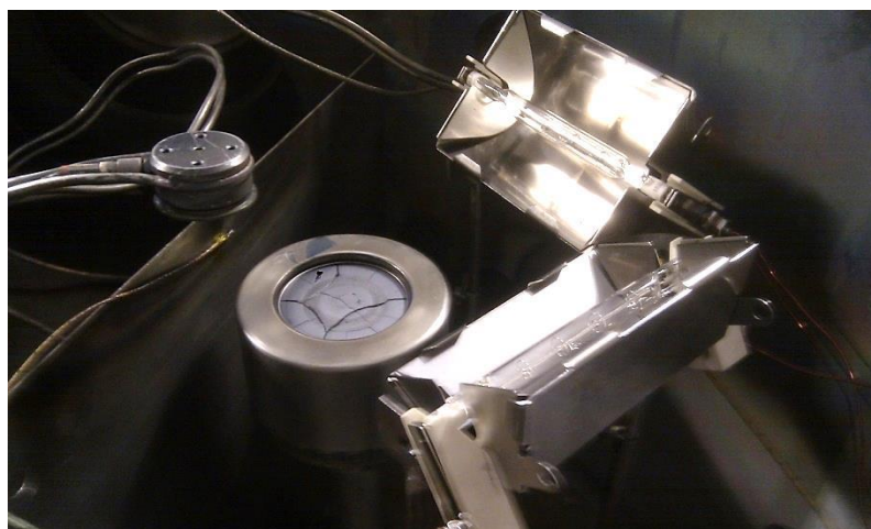
Figura 5.16 – Lâmpadas de aquecimento posicionadas no interior da câmara de vácuo.
